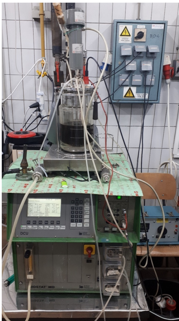
Slika 5. Bioreaktor s miješalom Biostat MD (izvor: vlastita fotografija)
