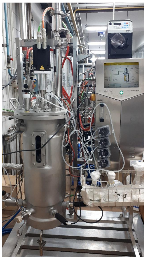
Slika 5. Bioreaktor s miješalom Biostat Cplus (Sartorius BBI Systems GmbH, Njemačka) (vlastita fotografija)
