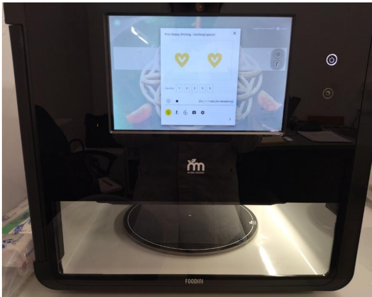
Slika 6. a) Foodini – uređaj korišten za 3D ispis ; b) Mlaznica Foodini-ja napunjena smjesom kaše maginje i škroba (Vlastita fotografija)
