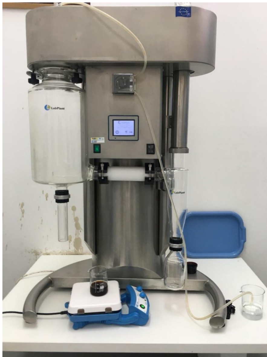
Slika 15. Sušionik s raspršivanjem Lab-Plant SD-60 (Velika Britanija) (vlastita fotografija, 2017)
