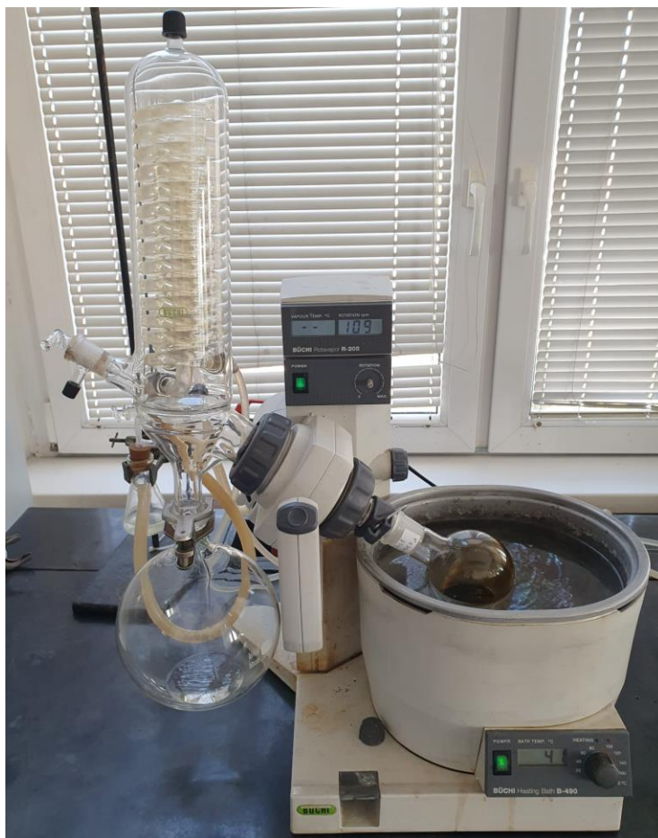
Slika 6. Uparavanje uzoraka u vakuum-uparivaču [autorski rad].
