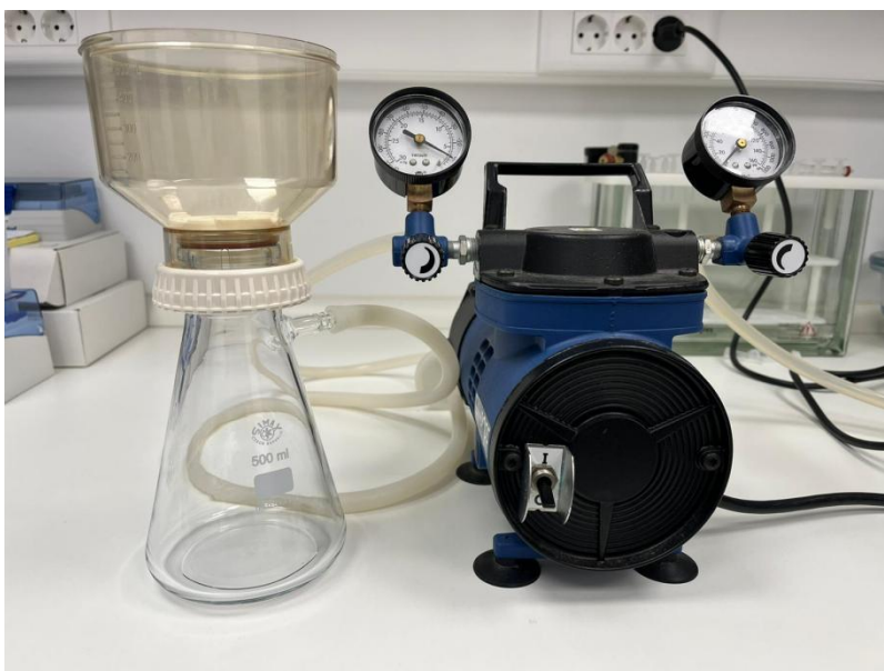
Slika 1. Aparatura korištena za filtraciju uzoraka morske vode u laboratoriju (vlastita fotografija)
