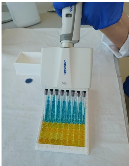
Slika 12. Prikaz pripreme uzoraka za određivanje razine hormona imunokemijskom metodom ELISA
