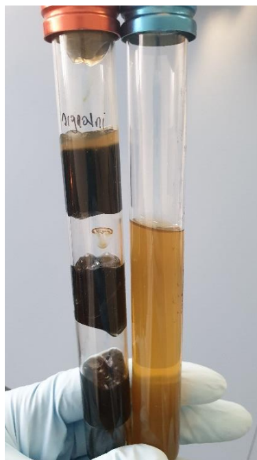
Slika 5. Uzorak pozitivan (lijevo) i negativan (desno) na sulfito-reducirajuće klostridije (vlastita fotografija)
