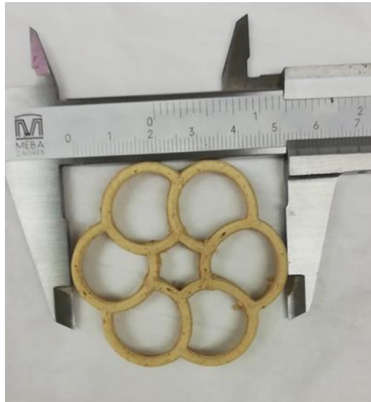
Slika 4. Mjerenje dimenzija (širina) pomoću kalipera (vlastita fotografija)
