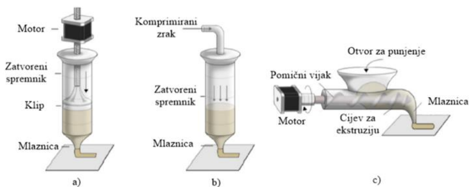
Slika 1. Mehhanizmi ekstruzije u 3D tiskanju hrane (Sun i sur., 2017.; prijevod Grgić, 2020.)
