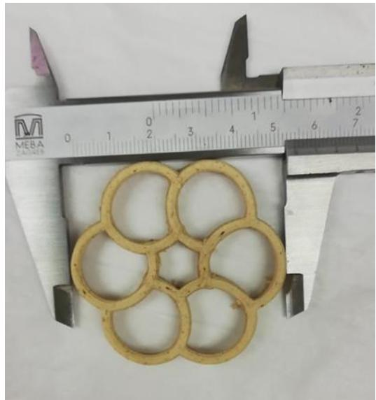
**Slika 4.** Mjerenje dimenzija (širina) pomoću kalipera (vlastita fotografija)
