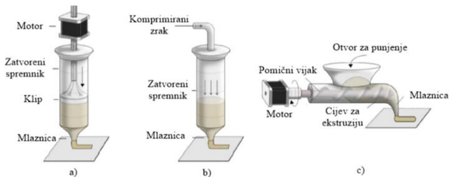
Slika 1. Mehanički dijagrami triju vrsta 3D tiskanja na principu ekstruzije (Sun i sur., 2017.; prijevod Grgić, 2020.)
