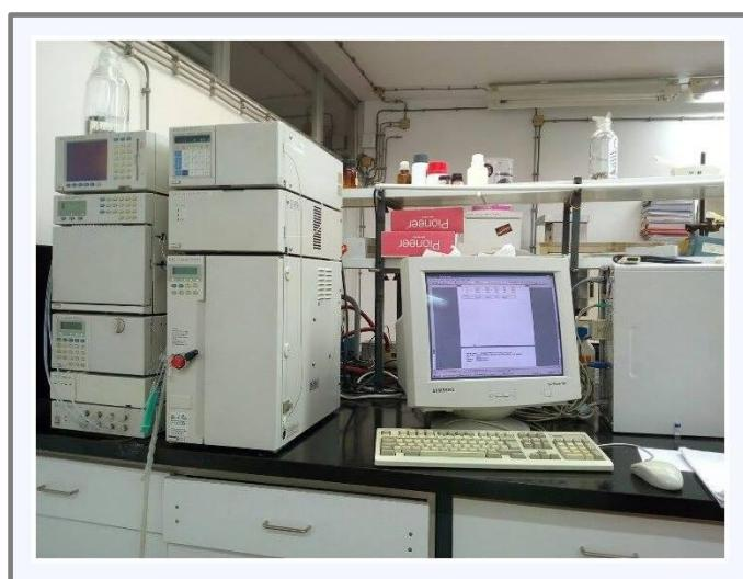
**Slika 6.** Shimadzu CLASS-VP LC-10AVP sustav za kromatografiju (Shimadzu, Kyoto, Japan)
