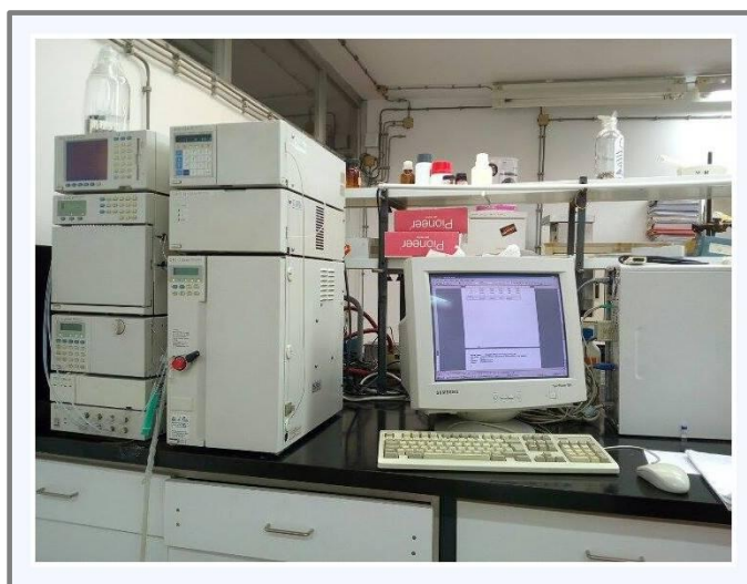
Slika 6. Shimadzu CLASS-VP LC-10A VP sustav za kromatografiju (Shimadzu, Kyoto, Japan) (vlastita fotografija)
