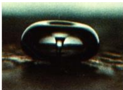
Slika 5. Kavitacijski mjehurić (Suslick, 1989)
