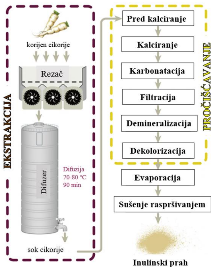
Slika 4. Industrijski proces proizvodnje inulina iz korijena cikoriје (prema Zhu i sur., 2016).
