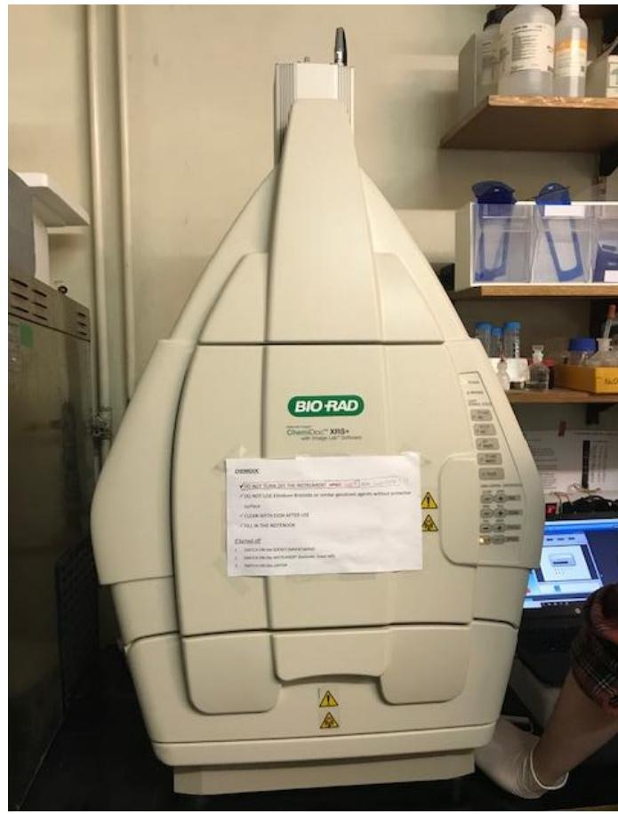
**Slika 4.** Uređaj za detekciju kemiluminiscentnog signala na membrani
