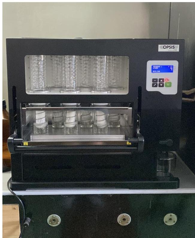
**Slika 5.** SOXROC aparatura za ekstrakciju ulja (vlastita fotografija)
