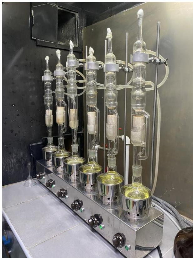
**Slika 4.** Soxhlet aparatura za ekstrakciju ulja (vlastita fotografija)
