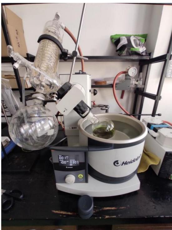
**Slika 7:** Rotacijski uparivač (vlastita fotografija)
