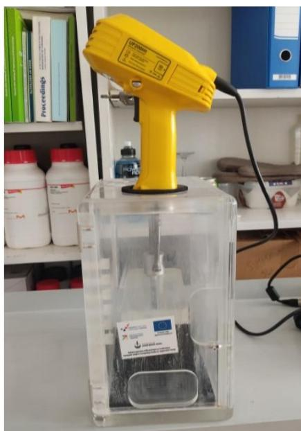
**Slika 6:** Ultrazvučna sonda (vlastita fotografija)
