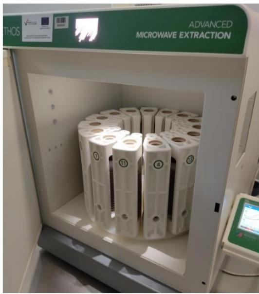
**Slika 5:** Uređaj za mikrovalnu ekstrakciju (vlastita fotografija)
