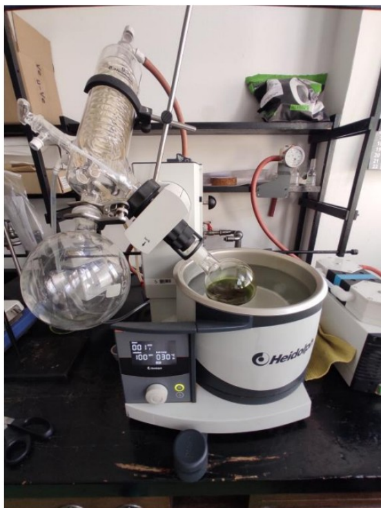
Slika 7: Rotacijski uparivač (vlastita fotografija)
