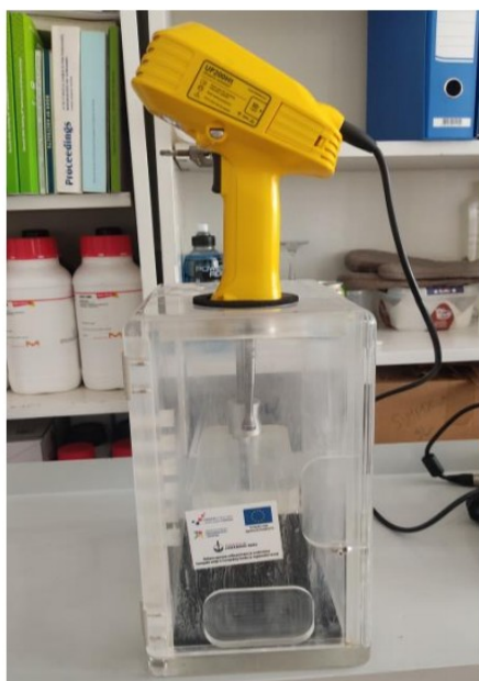
Slika 6: Ultrazvučna sonda (vlastita fotografija)
