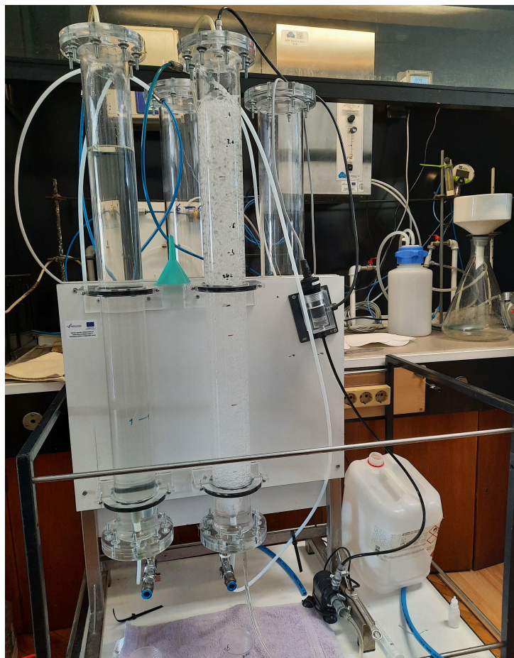
Slika 5. Generator ozona i kolone s vodom koja se ozonira
