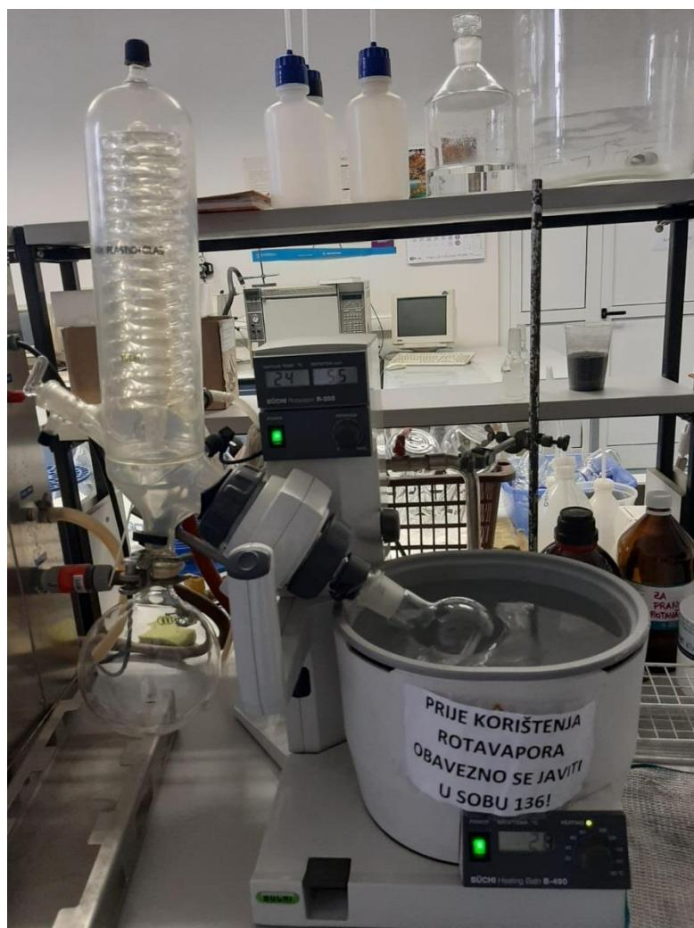
**Slika 7.** Otparavanje otapala na rotavaporu R-205 BUCHI Labortechnik AG CH-9230
