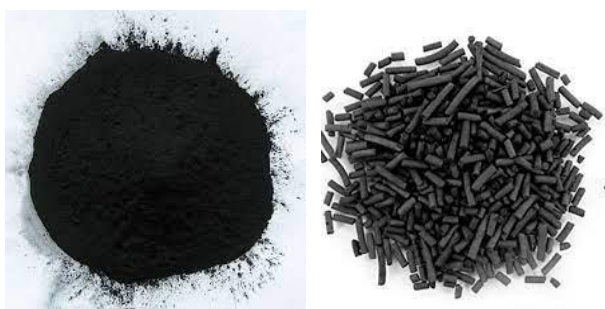
Slika 4. Različiti oblici aktivnog ugljika (Grubišić Čabo, 2019).
