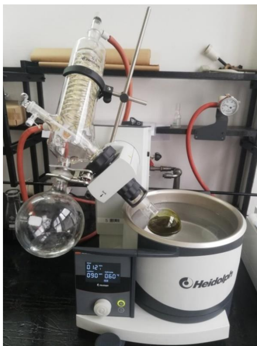
Slika 6. Uparavanje ekstrakta na rotirajućem uparivaču (osobne fotografije)
