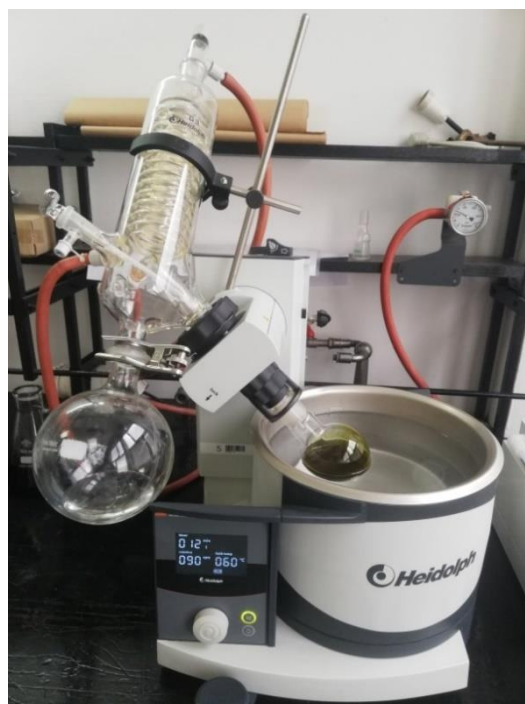
Slika 6. Uparavanje ekstrakta na rotirajućem uparivaču (osobne fotografije)
