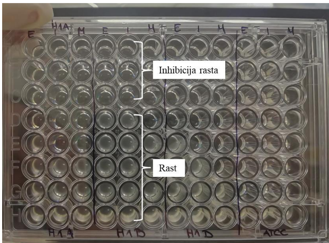
Slika 14. Primjer mikrotitarske pločice gdje se nakon 18 sati inkubacije na 35 °C određivala vrijednost minimalne inhibitorne koncentracije (MIK) tj. koncentracije pri kojoj dolazi do vidljive inhibicije rasta bakterijske kulture (nema замуćenja)(vlastita fotografija)
