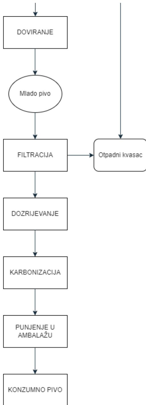
**Slika 7.** Blok shema proizvodnje piva - *nastavak* (vlastiti prikaz, nastavak)
