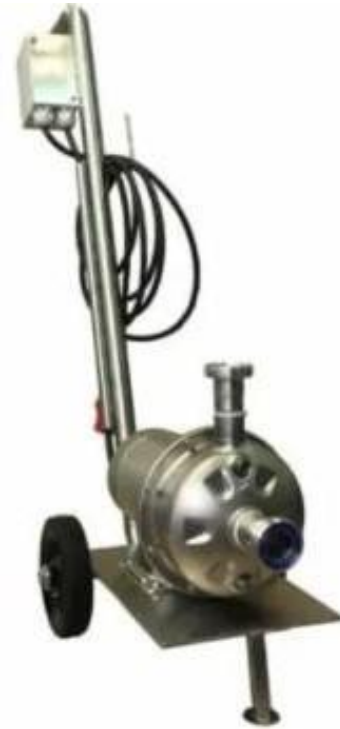
Slika 10. Mobilna centrifugalna pumpa MP-75 (CZB, 2022d)
