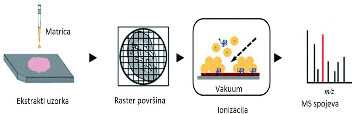
Slika 4. Prikaz osnovnog postupka MALDI-MS analize (Cleland i Schroeter, 2018)
