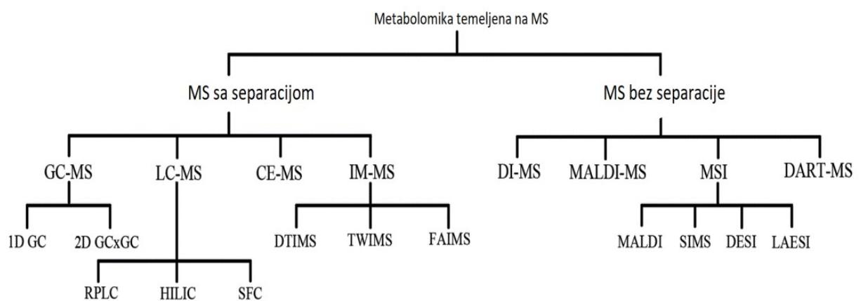
**Slika 3.** Tehnologije temeljene na MS koje se trenutno koriste u metabolomici (popis kratica objašnjen je u Prilogu 1). CE: kapilarna elektroforeza; DART: izravna analiza u stvarnom vremenu; DESI: desorpција и ionizација elektroraspršenjem; DI: izravna infuzија; DTIMS/TWIMS: spektrometrija masa ionske pokretljivosti; FAIMS: spektrometrija masa
