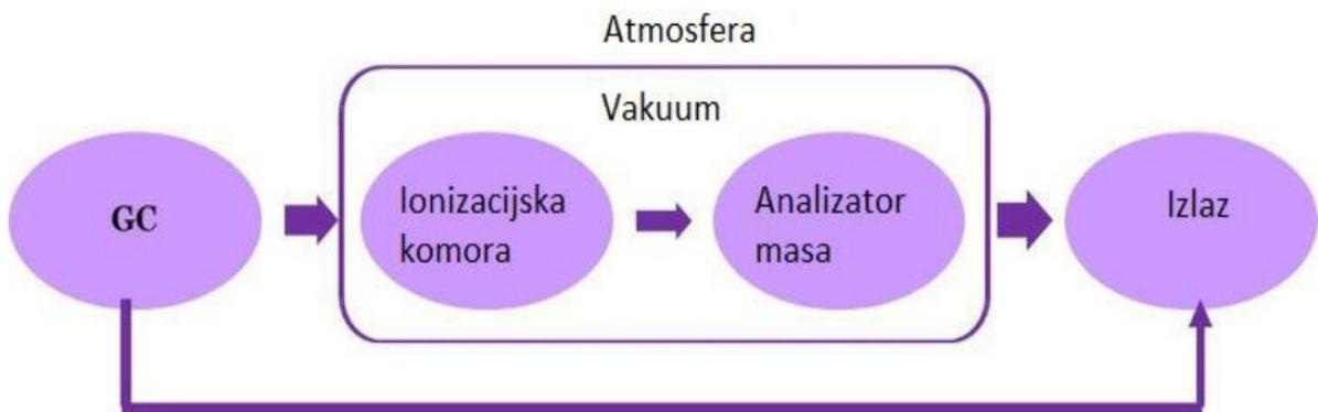
**Slika 6.** Shematski prikazane komponente sustava GC-MS (Bouziani i Yahya, 2021)
