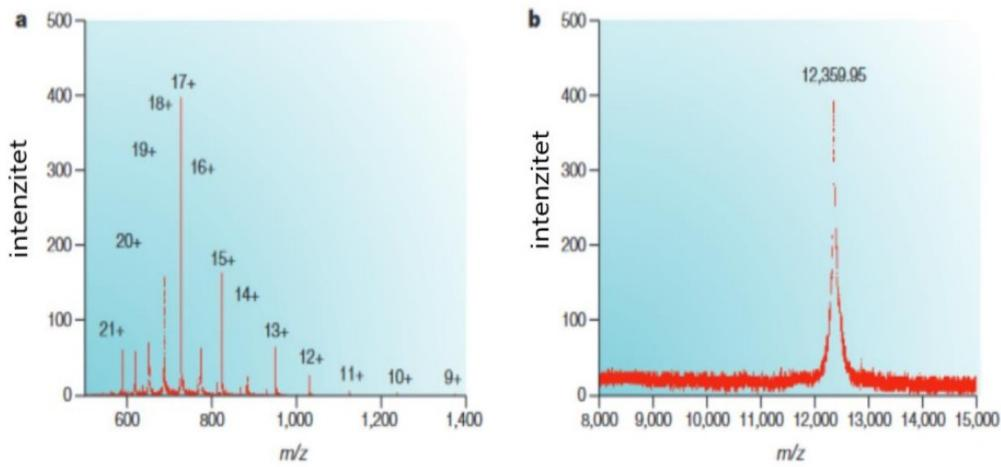
**Slika 3.** Usporedba spektra masa citokroma c primjenom ionizacije elektroraspršenjem (ESI) i matricom potpomognute ionizacije laserskom desorpcijom (MALDI); Spektar a) ESI; Spektar b) MALDI (Glish i Vachet, 2003)
