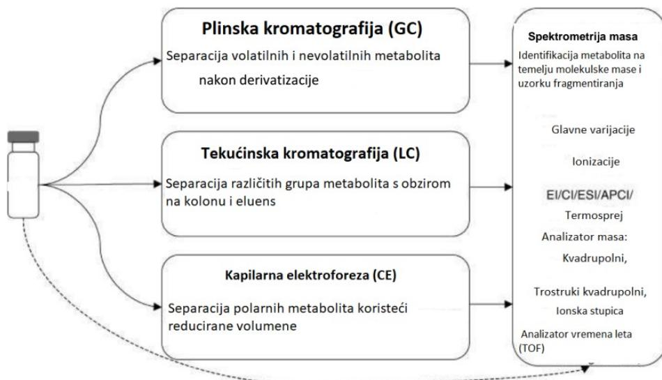
**Slika 5.** Shematski prikaz osnovnih separacijskih tehnika analize (Villas-Bôas i sur., 2004)
