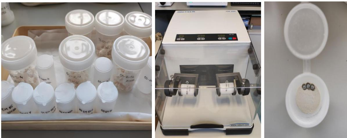
**Slika 4.** S lijeva na desno: posudice s uzorcima nakon liofilizacije, uređaj za homogenizaciju (MM 400 Retsch, Njemačka), homogenat ribljeg mišića u posudici s volframovim kuglicama
