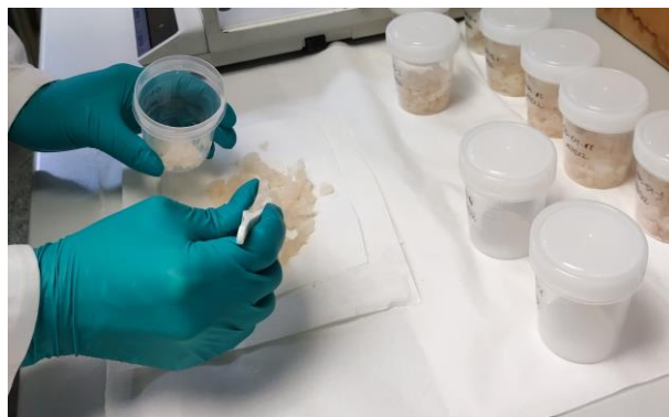
Slika 3. Usitnjavanje i pripremanje uzorka mišićja ribe za vaganje
