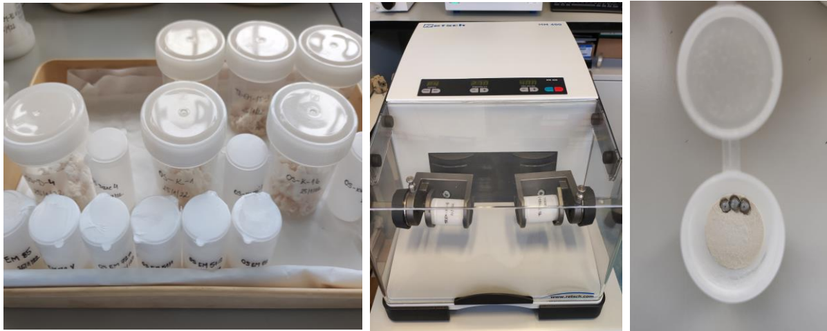
Slika 4. S lijeva na desno: posudice s uzorcima nakon liofilizacije, uređaj za homogenizaciju (MM 400 Retsch, Njemačka), homogenat riblji mišić u posudici s volframovim kuglicama
