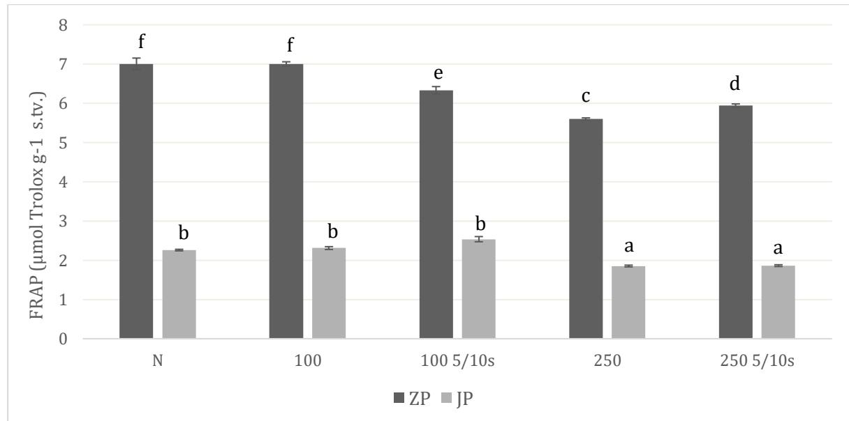
**Slika 13.** Antioksidacijska aktivnost ( $\mu\text{mol Trolox g}^{-1}$  s. tv.) određena FRAP metodom u uzorcima zobenih i ječmenih posija pri različitim uvjetima tretmana ultrazvukom visokog intenziteta (100, 250 – utrošak energije po volumenu uzorka, 5/10s – pulsirajući tretman) u odnosu na nativne posije (N). Različita slova označavaju statistički značajnu razliku između dobivenih vrijednosti ( $p < 0,05$ ).
