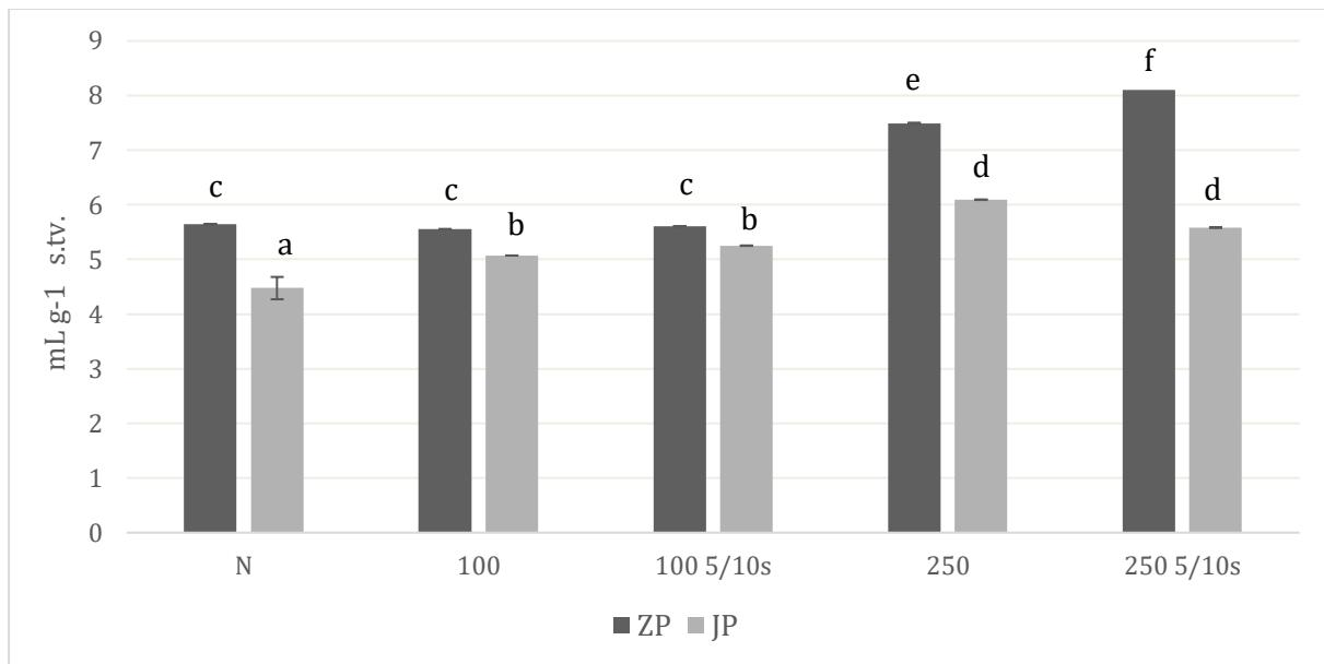
**Slika 11.** Bubrenje u vodi ( $\text{mL g}^{-1}$  s.t.v.) u uzorcima zobenih i ječmenih posija pri različitim uvjetima tretmana ultrazvukom visokog intenziteta (100, 250 – utrošak energije po volumenu uzorka; 5/10s – pulsirajući tretman) u odnosu na nativni uzorak (N). Različita slova označavaju statistički značajnu razliku između dobivenih vrijednosti ( $p < 0,05$ ).
