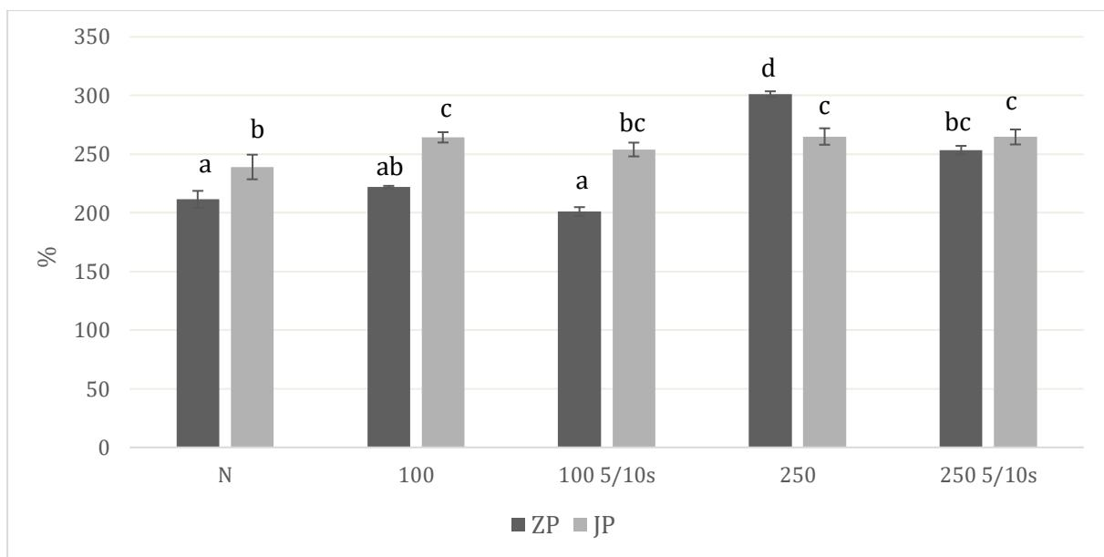
**Slika 10.** Kapacitet zadržavanja vode (%) u uzorcima zobenih i ječmenih posija pri različitim uvjetima tretmana ultrazvukom visokog intenziteta (100, 250 – utrošak energije po volumenu uzorka; 5/10s – pulsirajući tretman) u odnosu na nativni uzorak (N). Različita slova označavaju statistički značajnu razliku između dobivenih vrijednosti ( $p < 0,05$ ).
