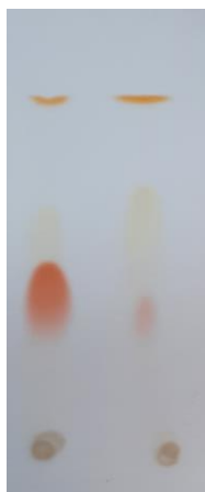
Slika 16. Primjer pločice presvučene silikagelom nakon provedene tankoslojne kromatografije (vlastita fotografija)
