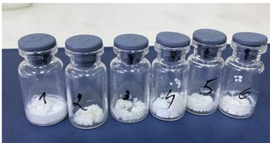
Slika 4. Liofilizirane mikroformulacije raličitih omjera alginata i želatine soja L. plantarum MB18. Uzorci: 1 - 100 % alginata i 0 % želatine, 2 - 90 % alginata i 10 % želatine, 3 - 80 % alginata i 20 % želatine, 4 - 70 % alginata i 30 % želatine, 5 - 60 % alginata i 40 % želatine, 6 - 50 % alginata i 50 % želatine
