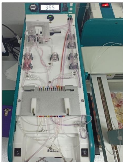
Slika 10. Analitička jedinica sa sustavom cijevi u kojima se odvija kontinuirani protok ( vlastita fotografija )
