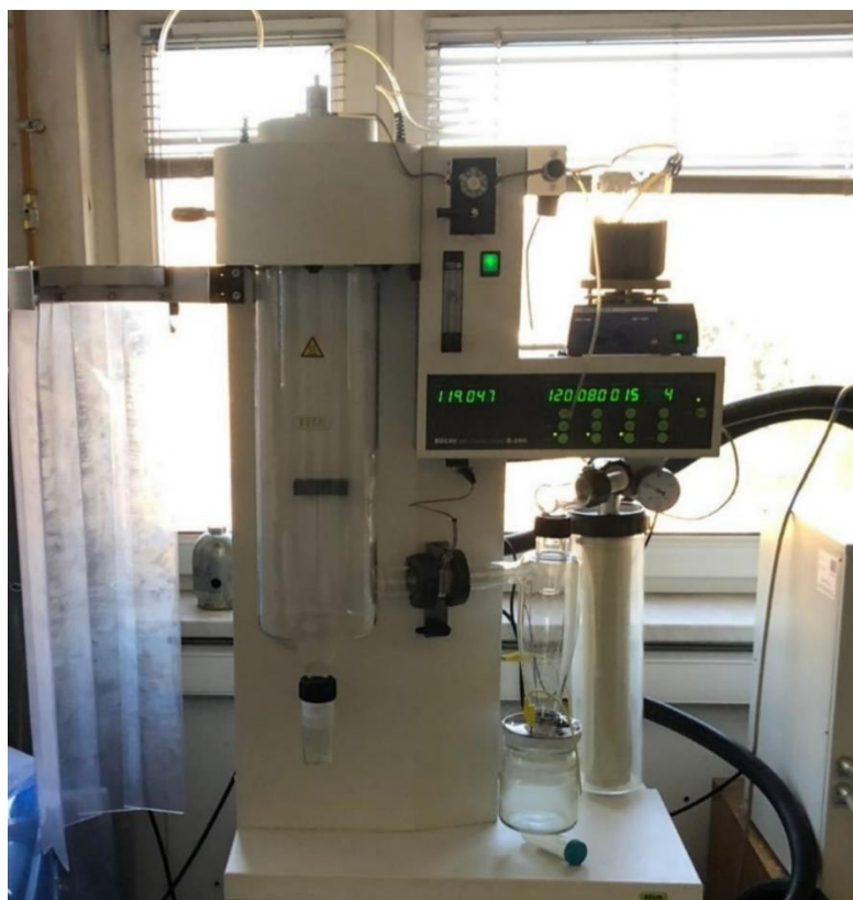
Slika 6. Laboratorijski uređaj za sušenje raspršivanjem Büchi Mini Spray Dryer B-290, Švicarska ( vlastita fotografija )
