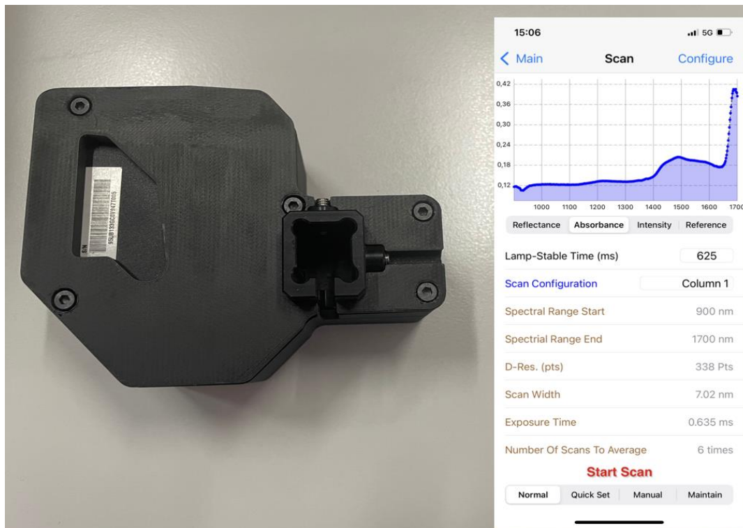
Slika 6. NIR spektroskopija s on-line praćenjem
