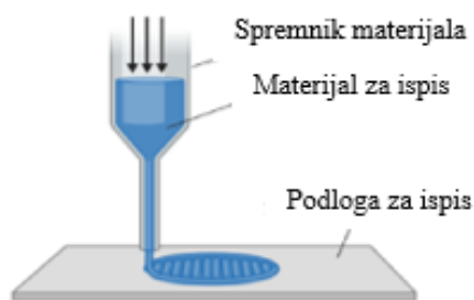
Slika 2. Shematski prikaz tiskanja na bazi ekstruzije (prema Varvara i sur., 2021)
