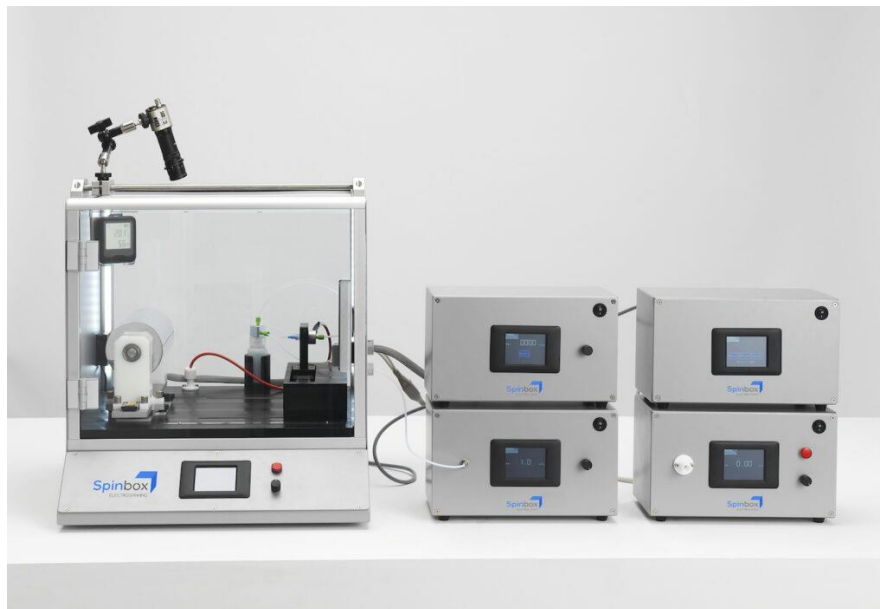
Slika 3. Spinbox uređaj za elektroispredanje (Anonymous 2, 2023)
