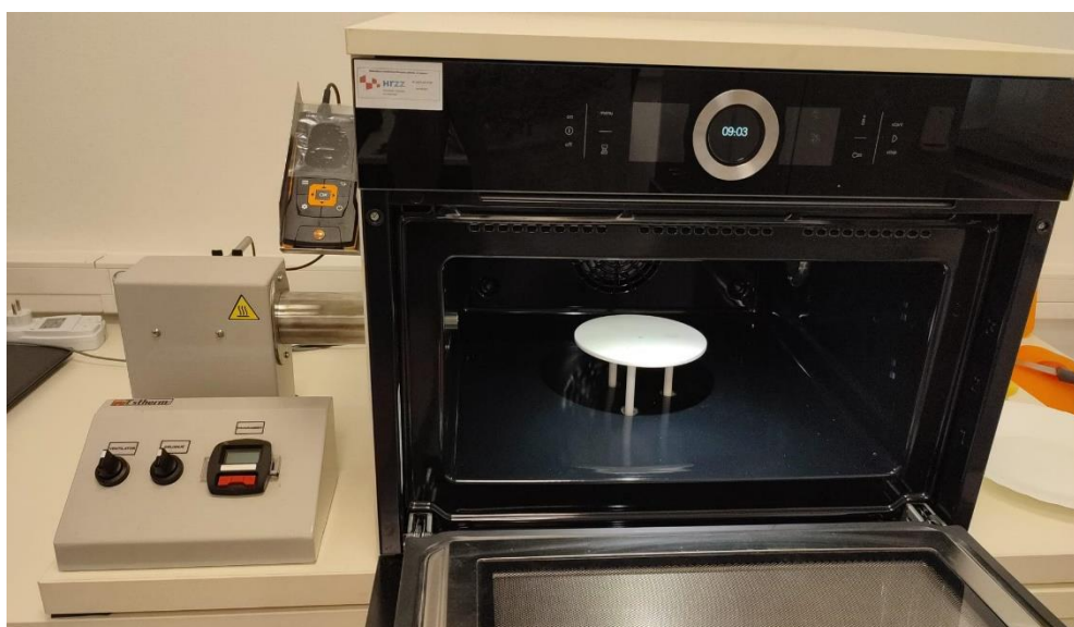
Slika 4. Hibridna mikrovalno-konvekcijska sušara (Estherm, Hrvatska)
