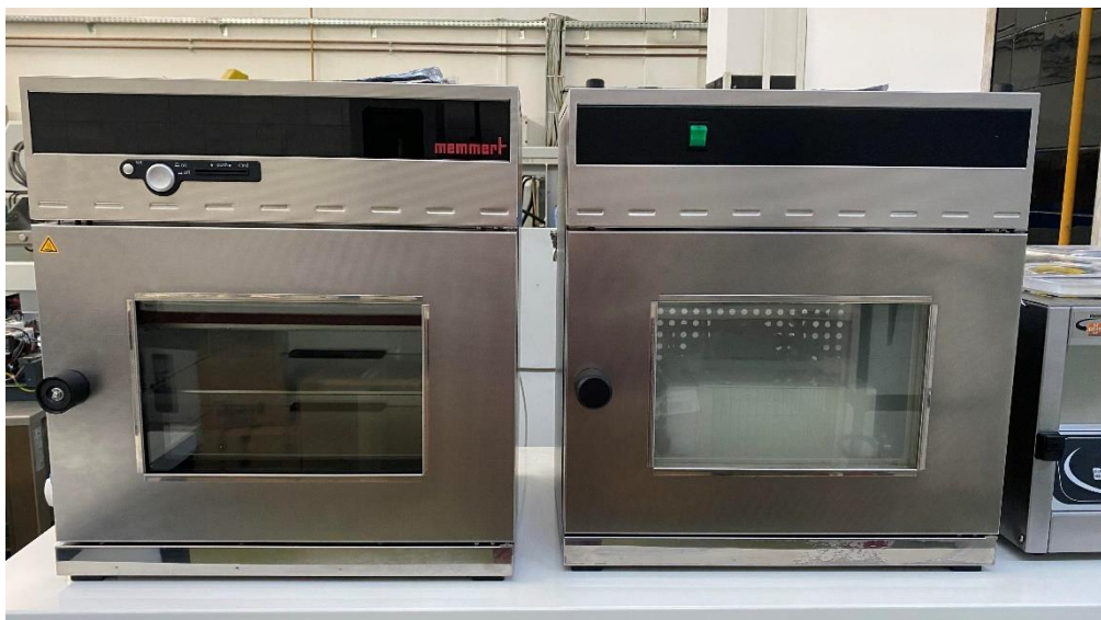
Slika 3. Kondukcijska vakuum sušara VO200 PM200 tvrtke Memmert (vlastita fotografija)
