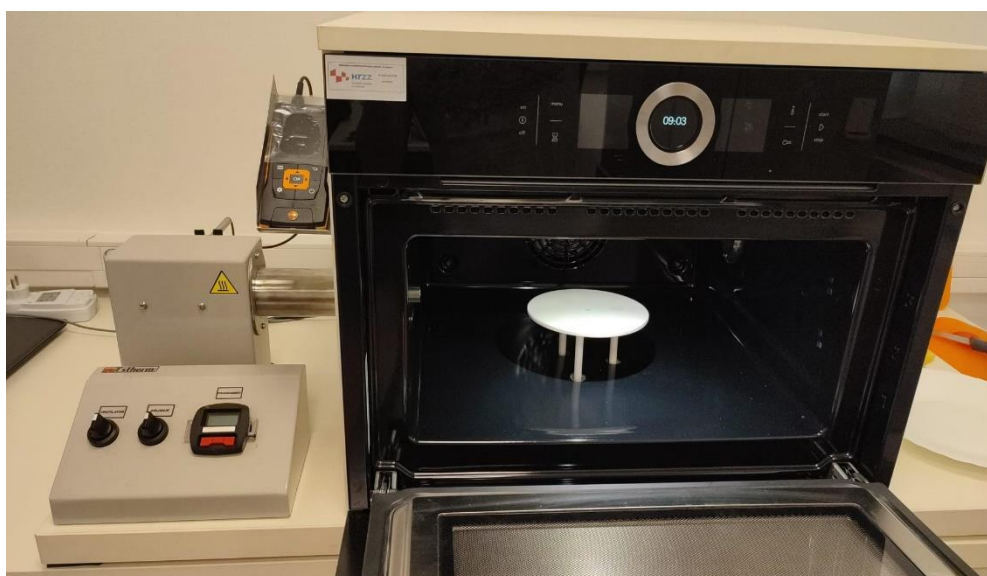
Slika 4. Hibridna mikrovalno-konvekcijska sušara (Estherm, Hrvatska)
