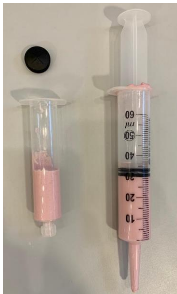
Slika 3. Prijenos pripremljene smjese iz veće u manju štrcaljku s ciljem što bolje eliminacije mjehurića zraka ( vlastita fotografija )
