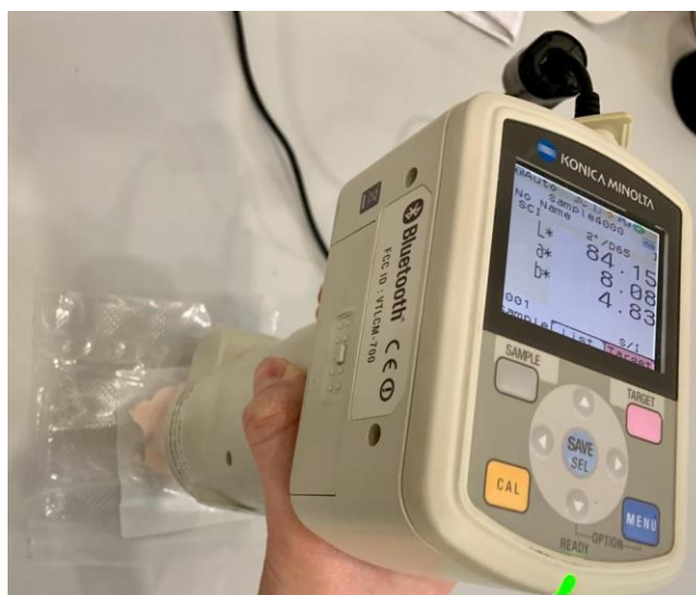
Slika 5. Određivanje parametara boje na ispisanom uzorku primjenom spektrofotometra Konica Minolta CM-700d ( vlastita fotografija )
