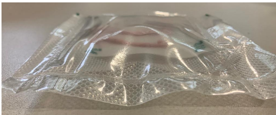
Slika 6. Gotovi ispisani oblik u plastičnoj vrećici s dušikom ( vlastita fotografija )
