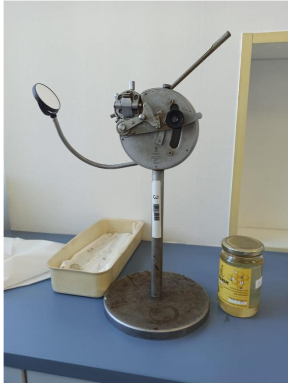
Slika 4. Aparatura za mjerenje indeksa refrakcije ( vlastita fotografija )
