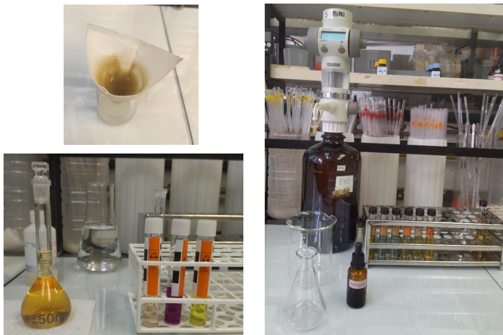
Slika 8. Uzorak za analizu KPK, \text{NH}_4\text{-N} , \text{NO}_3\text{-N} , \text{NO}_2\text{-N} i \text{PO}_4\text{-P}
