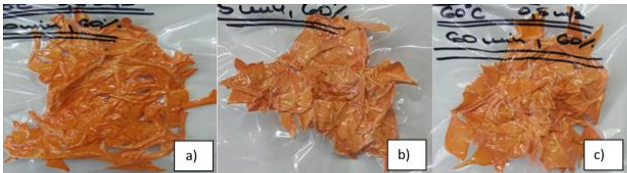
Slika 18. Uzorci bundeve predtretirani indirektnim ultrazvučnim postavom pri amplitudi od 60 % u vremenu trajanja: a) 30 min; b) 45 min i c) 60 min
