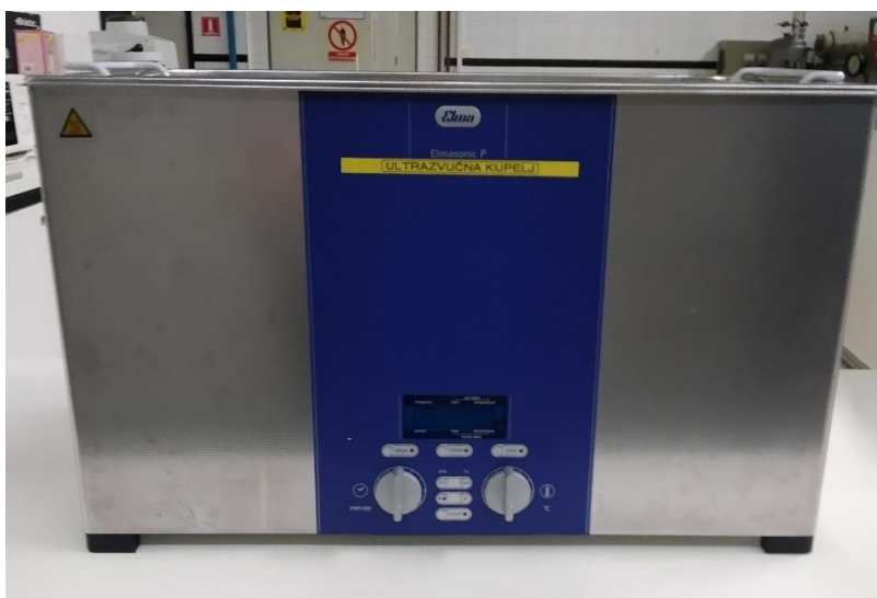
Slika 5. Indirektni ultrazvučni postav Elmasonic P 300 H (vlastita fotografija)
