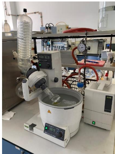
Slika 7. Otparivanje otapala pomoću rotavapora (vlastita fotografija)
