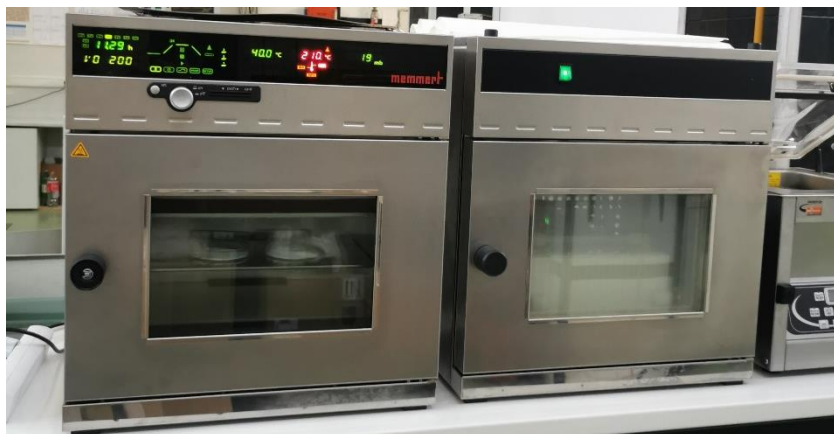
Slika 3. Kondukcijska vakuum sušara VO200 PM200 (Mettler GmbH + Co. KG, Njemačka) (vlastita fotografija)
