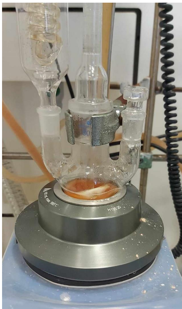
Slika 4. Sinteza onečišćenja RRT 1,37 u trogloj tikvici od 0,5 L (vlastita fotografija, 2023)
