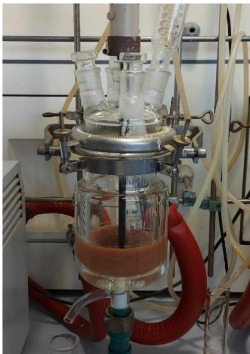
Slika 3. HWS stakleni 1 L reaktor s dvostrukim plaštom i ispustom na dnu (vlastita fotografija, 2023)
