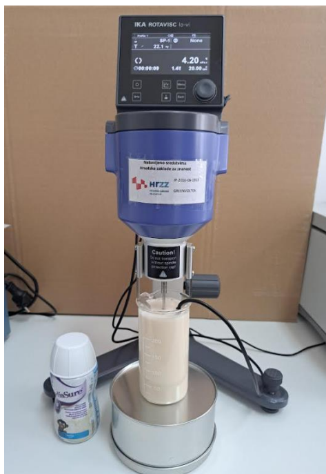
Slika 7. Korišten rotacijski viskozimetar Rotavisc lo-vi Complete ( vlastita fotografija )
