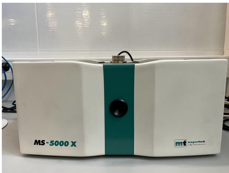
Slika 7. Magnetech MS – 5000 X (Freiburg instruments) EPR spektrometar ( vlastita fotografija )
