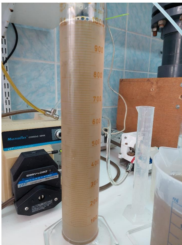
Slika 41. Efluent 6. dana nakon aeracije u SDOX-u
