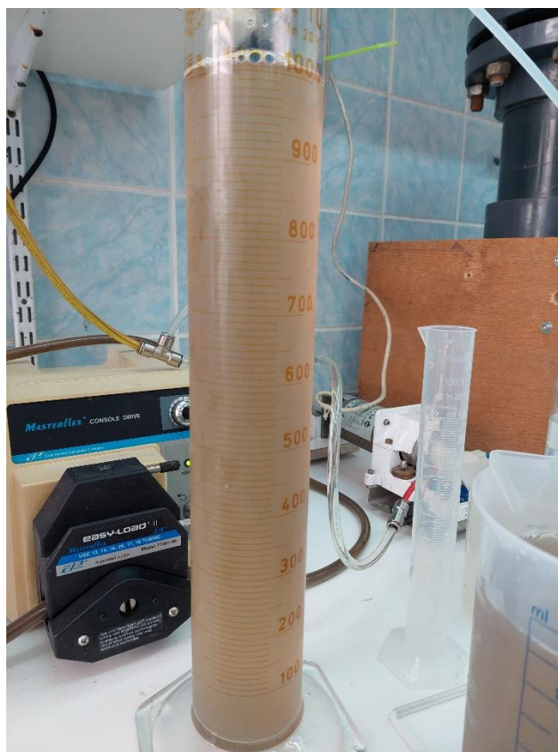
Slika 41. Efluent 6. dana nakon aeracije u SDOX-u
