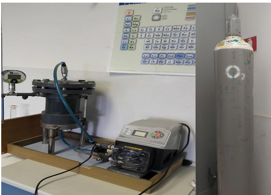
Slika 9. Laboratorijski SDOX uređaj (vlastita fotografija)
