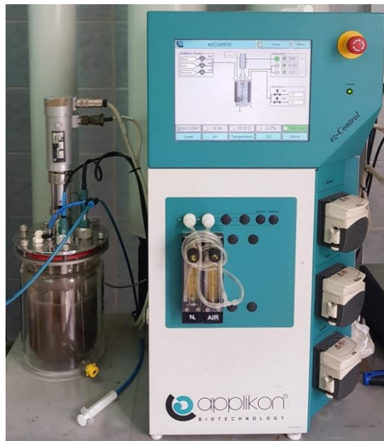
Slika 10. SBR tvrtke “Applikon“ (vlastita fotografija)
