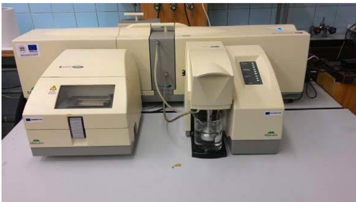
Slika 20. Malvern Mastersizer 2000 s vanjskom jedinicom Hydro 2000S (vlastita fotografija)
