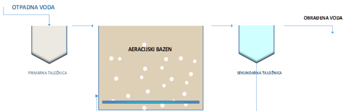
Slika 3. Shema konvencionalne obrade otpadne vode (preuzeto iz Metcalf i Eddy, 2014)
