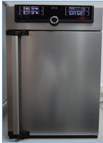
Slika 12 Termosta za određivanje udjela vode
