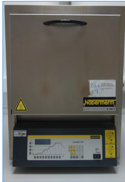
Slika 13 Mufolna peć za određivanje pepela
