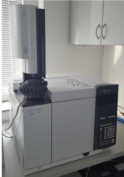
Slika 18 Plinski kromatograf (GC) s plameno-ionizacijskim detektorom (FID)
