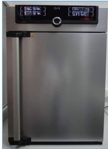
Slika 12 Termosta za određivanje udjela vode
