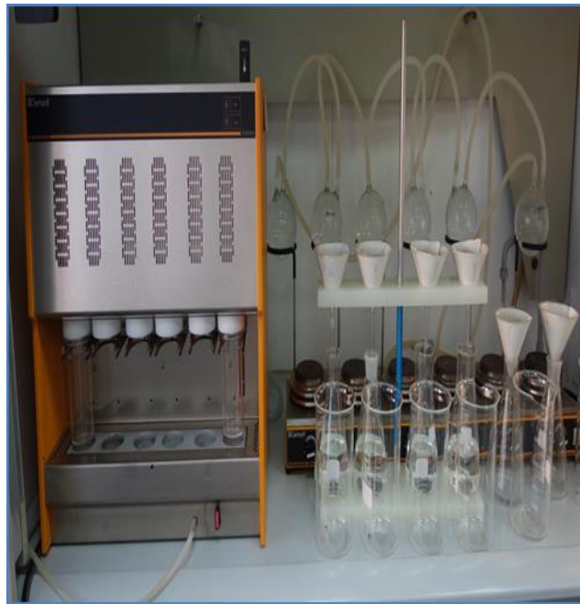
Slika 14 Uređaj za ekstrakciju masti metodom po Soxhlet-u
